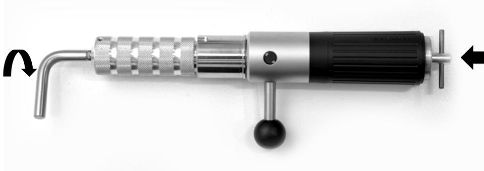
Spannzange reinigen, außen leicht einfetten und in die Welle einsetzen. Mit Schlüsseln wie oben beschrieben die Spannzange im Uhrzeigersinn bis zum Endanschlag einschrauben und leicht anziehen. Steckkörper wieder aufstecken und mit Kappe wieder verschrauben.
